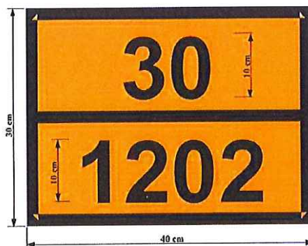
Przykład pomarańczowej tablicy identyfikacyjnej zawierającej numer identyfikacyjny zagrożenia oraz numer identyfikacyjny materiału dla oleju napędowego i opałowego 30UN1202
